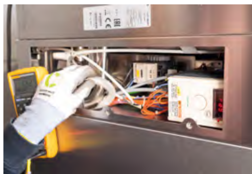
Všestranně přívětivá konstrukce Convotherm mini se svými čtyřmi servisními porty zjednodušuje, zrychluje a zlevňuje údržbu a opravy.
