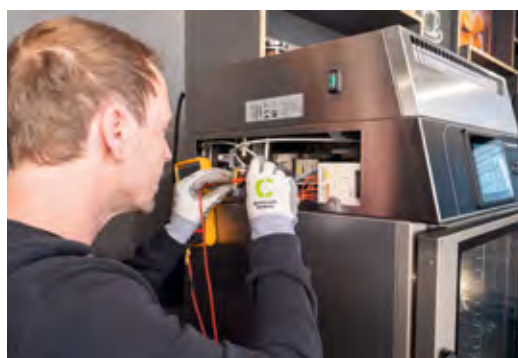
Všestranně přívětivá konstrukce Convotherm mini se svými čtyřmi servisními porty zjednodušuje, zrychluje a zlevňuje údržbu a opravy.
